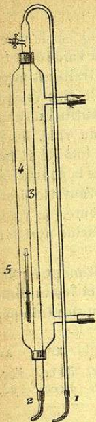
Fig. 91. Aérotonomètre de L. FRÉDÉRICQ.
