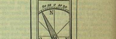
Le déclinateur est placé sur une planchette en station, de façon qu'on puisse lui donner une position parallèle à celle qu'il occupait à la station précédente. Pour tracer la direction du méridien magnétique, on fait tourner le déclinateur jusqu'à ce que l'aiguille vienne coïncider avec le diamètre O O du limbe; on trace alors une droite avec l'un des grands côtés de la boîte comme règle, et cette ligne est la direction cherchée.
