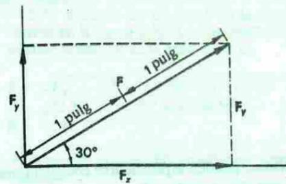
Fig. 2-6 Encontrando las componentes de una fuerza por medio del método gráfico.
