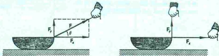
Fig. 2-4 La fuerza F ejercida a un ángulo, puede ser reemplazada por sus componentes horizontal y vertical.
