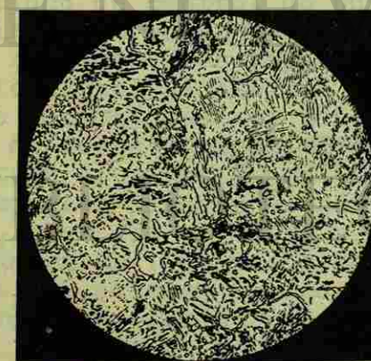
Fig. 22 Acero normal. Red de cementita, poca sorbita y perlita laminar, 500 X.
