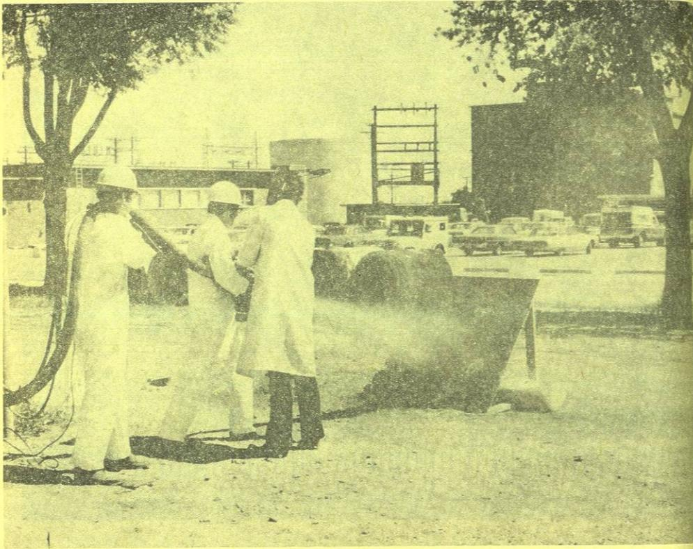
Foto 8.- Ensayando la aplicación del concreto de polímero lanzado.
