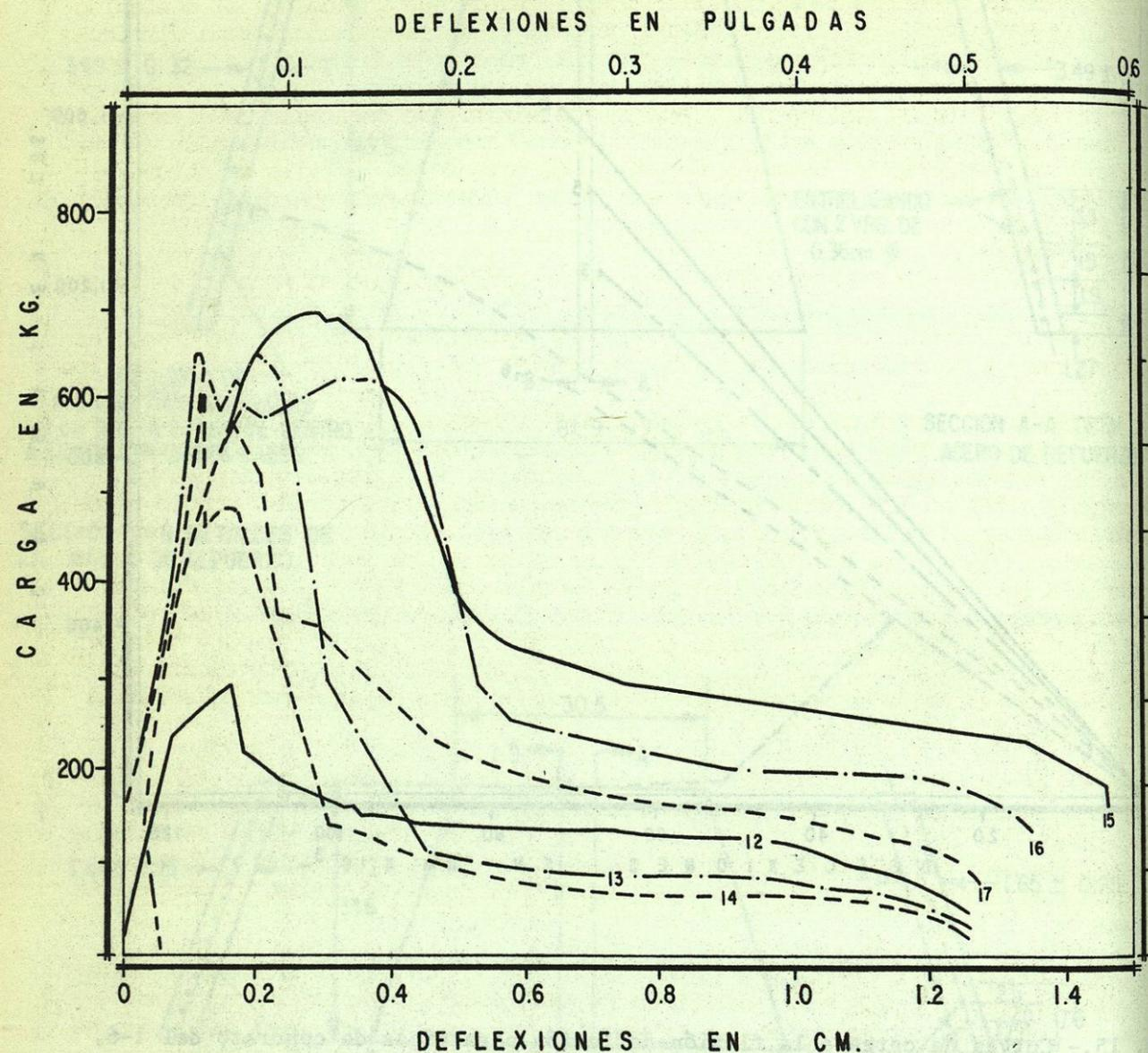
Fig. 16.- Curvas de carga-Deflexión para las vigas del 12-17 inclusive, reforzadas con fibra de acero (ver Tablas 3 y 4). El % de nBA disminuye en orden descendiente: 13, 14, 15, 16, 17, 12.
