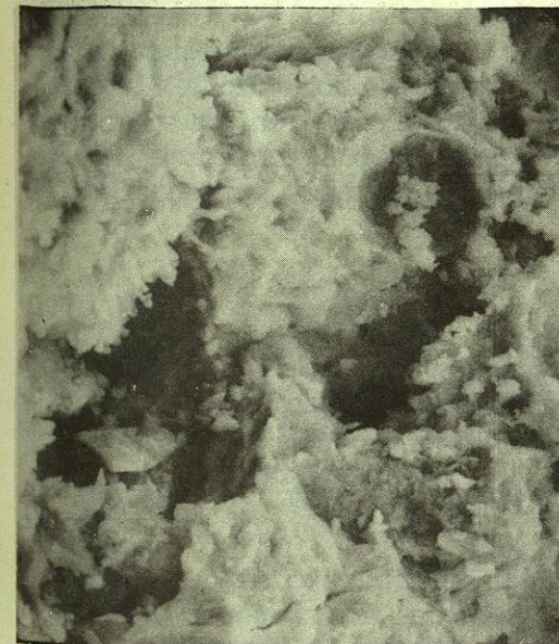
Agregado preparado a partir de concreto reciclado x625
