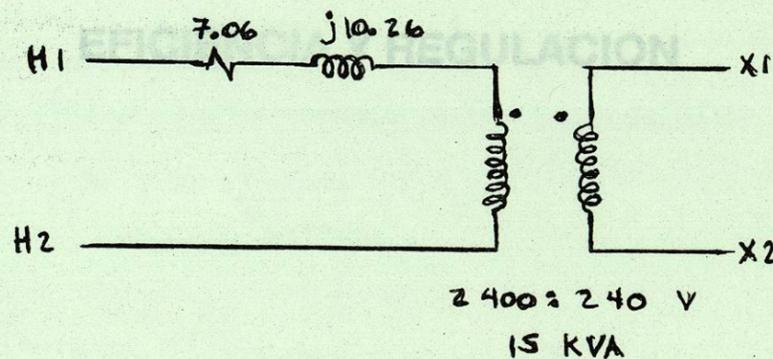
Si se desea obtener los parámetros de cada lado del transformador, utilizando la aproximación:
