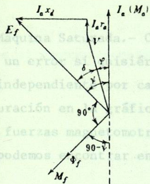
Fig. 7-1 Diag. vectorial de un Gen. síncrono no saturado con rotor cilíndrico - corriente atrasada.
