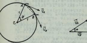
NOTA: El cambio de velocidad v' tiene esa posición, puesto que la velocidad en A, VA sumada vectorialmente a dicho cambio tiene como resultante VB.
