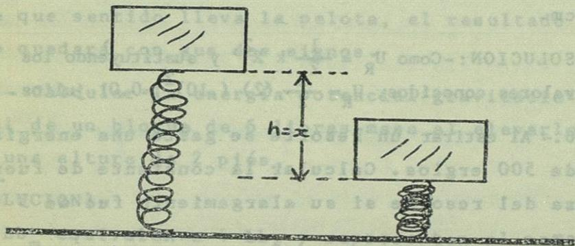
Al comprimir la caja al resorte, pierda energía potencial gravitacional:  $mgh$ , la cual se transforma en energía potencial elástica del resorte:  $\frac{1}{2} k x^2$ :
