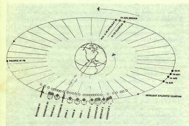
buena intensidad de campo la zona deseada. Una vez lanzado el satálite mediante un cohete propulsor, los técnicos desplazan en su órbita hasta colocarlo en el meridiano que le corresponde y lo orientan para que las antenas queden apuntando a la region de servi
