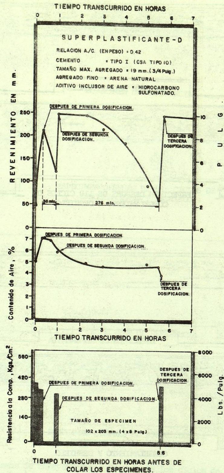
FIG. 5 TIEMPO TRANSCURRIDO DESDE EL MEZCLADO INICIAL CONTRA REVENIMIENTO, CONTENIDO DE AIRE Y RESISTENCIA A LA COMPRESION SUPERPLASTIFICANTE - D.
