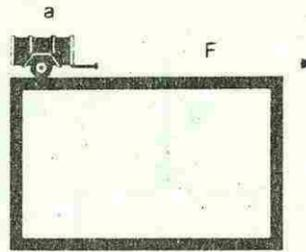
Fig. 3a. Si a la masa "m" se le aplica una fuerza "F", se produce una aceleración "a".
