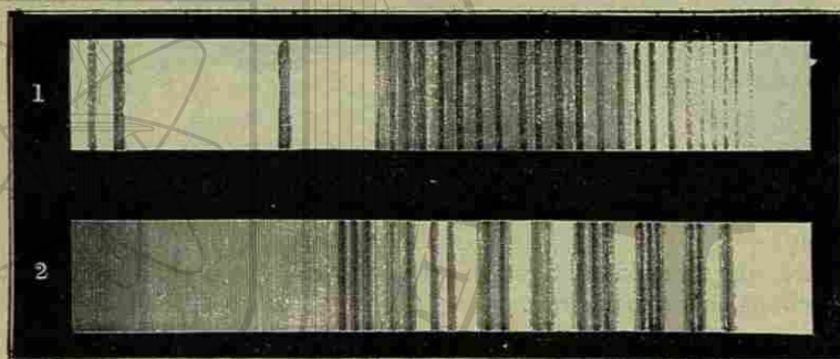
Fig. 179. - Espectros de absorción del yodo y de los vapores nitrosos
