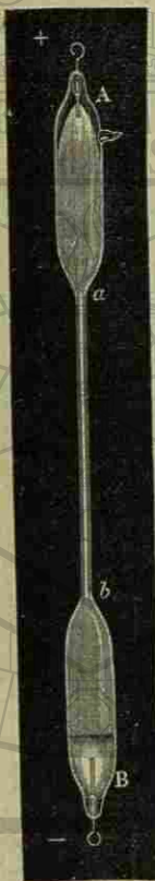
Fig. 176. - Tubo para el análisis espectral de los gases.
