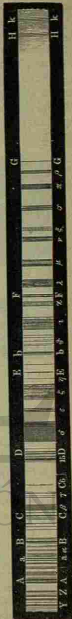
Fig. 181. — Espectro solar de Brewster y Gladstone con las líneas de absorción atmosférica.
