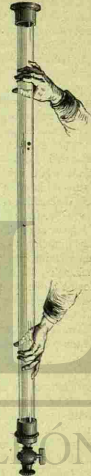
Fig. 99. - Tubo de Newton para demostrar la igualdad de velocidad de los cuerpos que caen en el vacío.
