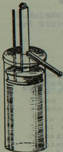
máquina de vapor atmosférica de Denis Papin, 1690.
