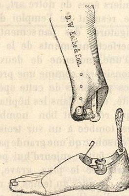
Fig. 512. — Mécanisme du cou-de-pied dans la jambe Kolbé.
