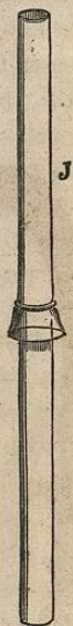
FIG. 18. — Anesthésimètre de Duroy (tube servant à l'introduction de l'air extérieur dans l'appareil).
