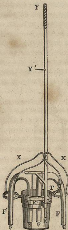
FIG. 14. — Anesthésimètre de Duroy (flacon gradué avec ses accessoires).
