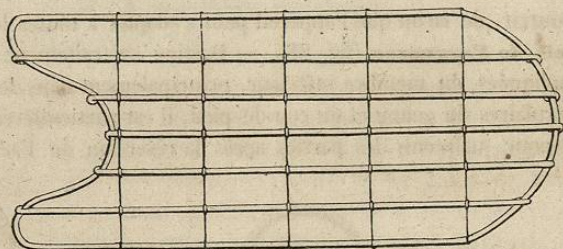
FIG. 89. — Grillage d'une gouttière de fil de fer d'après le système de Mayor.
