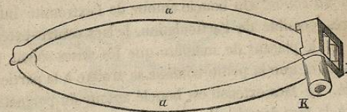
FIG. 194. — Ajusteur de Jarvis. — Pièce de contre-extension constituée par une fourchette articulée.
