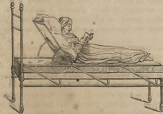
Fig. 304. — Lit mécanique de W. Hooper. — Chevet du cadre soulevé par un mécanisme propre.
