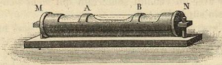
Fig. 60. — Niveau à bulle d'air.
