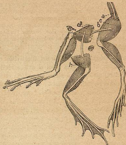
Fig. 82. — Pattes galvanoscopiques disposées pour la contraction induite : a-b-c est inducteur pour d-e, qui est à son tour inducteur pour h.
