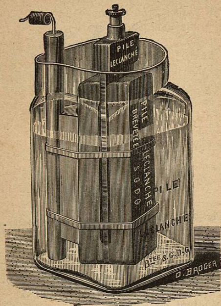
Fig. 65. — Élément Leclanché à aggloméré.
