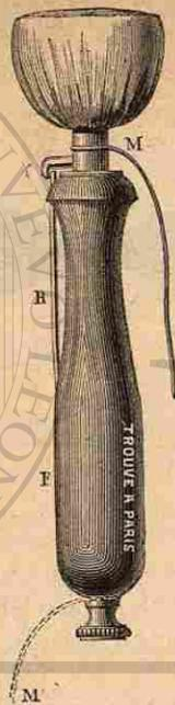
Fig. 230. — Electrode en charbon à manche interrupteur.
