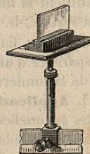
Fig. 680. — Plaques pour l'étude des pouvoirs diathermanes.
