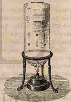
Fig. 685. — Courants produits dans un liquide chauffé.
