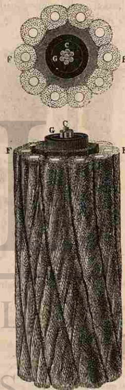
Fig. 475. — Câble transatlantique (grosseur réelle).
