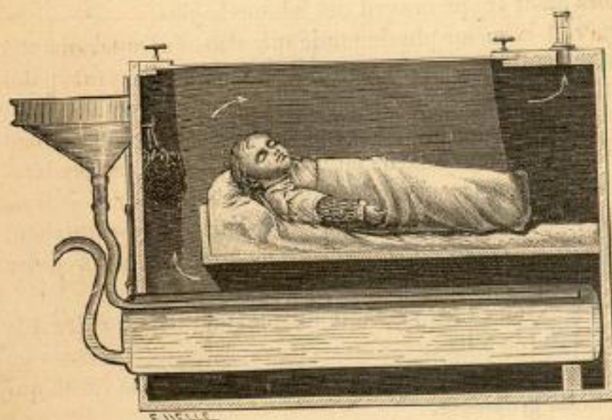
Fig. 582. — Couveuse Tarnier avec thermo-siphon.
