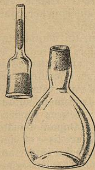
Fig. 1. — Le matras Pasteur et son bouchon à l'émeri. Celui-ci porte le tampon d'ouate obturateur.
