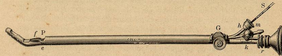
Fig. 71. — Cystoscope d'Albarran, avec la pièce urétérale montée. — e, tiges métalliques qui, actionnées par la roue G, font mouvoir l'onglet f sur lequel repose la sonde S, lorsque, en la poussant, on la fait sortir par l'orifice P; m, vis de pression contenant dans son intérieur une rondelle de caoutchouc percée pour laisser passer la sonde S; r, canal irrigateur muni d'un robinet.
