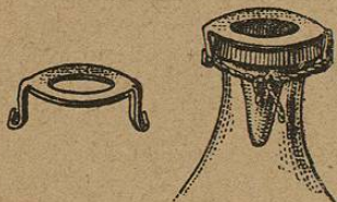
Fig. 133. — Armature métallique destinée à maintenir l'obturateur. Armature métallique appliquée.
