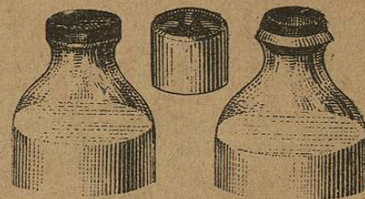
Fig. 130. — Obturateur Soxhlet. A gauche : ouverture d'une bouteille munie de la rondelle obturatrice, avant stérilisation. Au milieu : capsule en métal destinée à maintenir le disque en place. A droite : rondelle enfoncée dans le goulot sous la pression atmosphérique.
