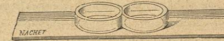
Fig. 22.—Doble célula del cromómetro de Hayem: una está llena de sangre diluida y la otra de agua pura colocada encima de un color que se toma como punto de comparación.
