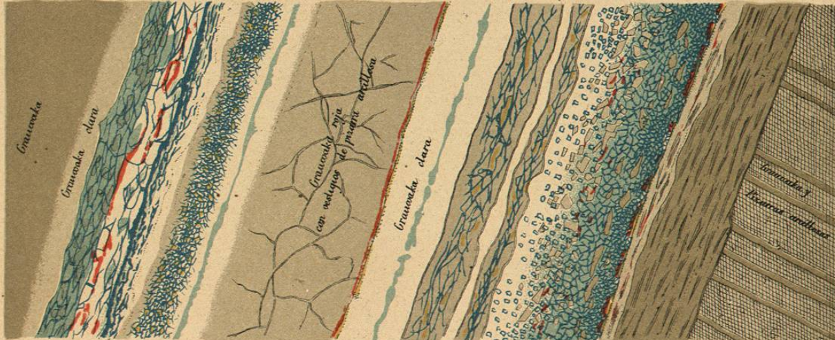
Escala de 100 metros. Mineral de plomo argentífero, Cuarzo ó cristal de roca, id. de hierro carbonatado, Caliza espática, id. de hierro sulfurado, Pizarras arcillosas, Blenda ó zinc sulfurado, Granitas rojas claras etc. Rocas intercaladas.
