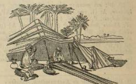
Bébéme tenant sur un mûrier fixé à terre (P. 13). (D'après Heilbrunn).
