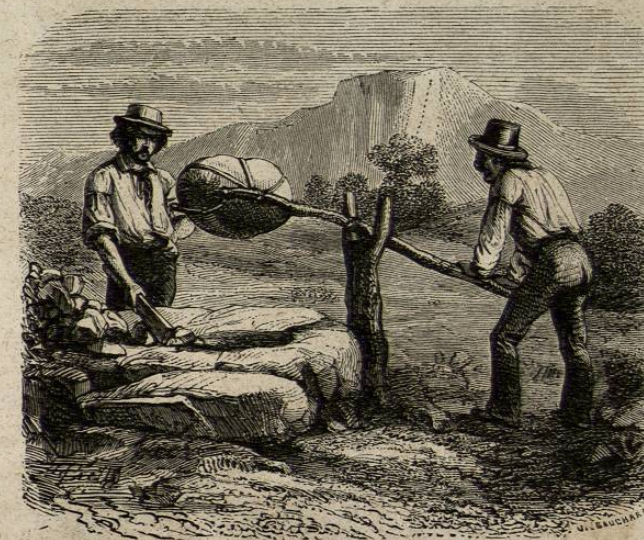
Trituración del mineral por el antiguo método mejicano.
