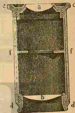
Fig. 29. — Corte vertical del ocular: a, ocular propiamente dicho; b, lente del campo; f, diafragma.
