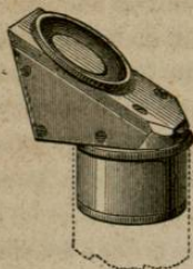
Fig. 98. — Emploi du prisme redresseur de Nachet.
