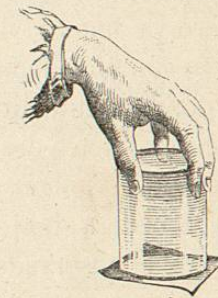
Fig. 18.—PRESION ATMOSFERICA BAJO UN VASO DE AGUA
