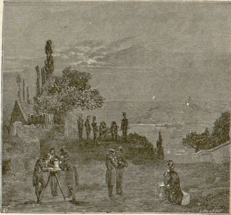
Fig. 40. —MEDIDA DE LA VELOCIDAD DEL SONIDO EN EL AIRE, POR LA OFICINA DE LONGITUDES
