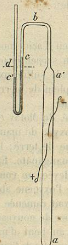
Fig. 57. — Diminution de volume de l'oxygène sous l'influence des étincelles électriques.
