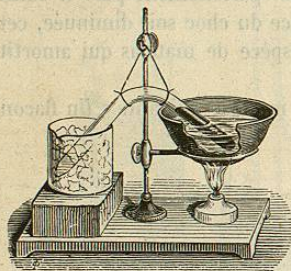
Fig. 104. — Liquéfaction du gaz ammoniac.
