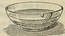
Fig. 156. — Cristallisation du soufre par évaporation lente de sa dissolution dans le sulfure de carbone.
