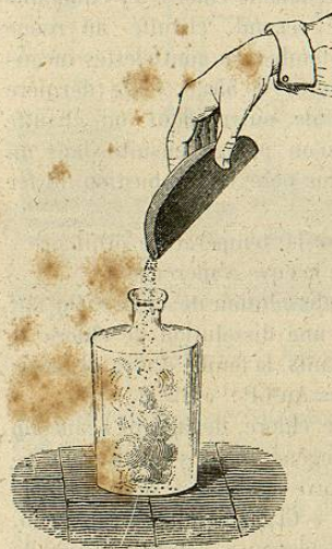
Fig. 171. — Combustion de l'arsenic ou de l'antimoine dans le chlore.
