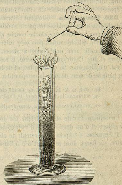
Fig. 186. — Action du zinc sur l'acide chlorhydrique
