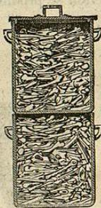
Fig. 216. — Marmites pour la calcination des os dans les fours.
