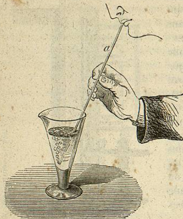
Fig. 226. — Eau de chaux traversée par l'air chargé d'acide carbonique, sortant des poumons.
