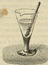
Fig. 295. — Décomposition d'un sel d'argent par une lame de cuivre.
