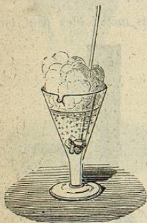
Fig. 504. — Action de l'acide azotique sur le cuivre.
