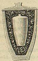
Fig. 584. — Préparation du manganèse dans un creuset de chaux entouré de chaux
